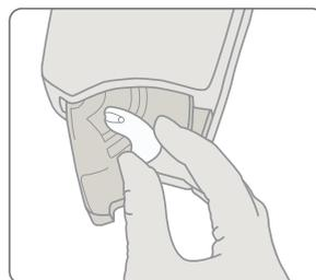
2 Legen Sie die Mikroküvette in den Analyzer ein.
